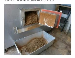
※写真の機械(処理機)はデモ専用機です。 ※出来た堆肥は、一次発酵処理品です。
