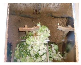
② この後生ゴミは槽内で攪拌され、高い温度により 高速発酵致します。高温により活性した発酵菌 は発酵した生ゴミを分解致します。
