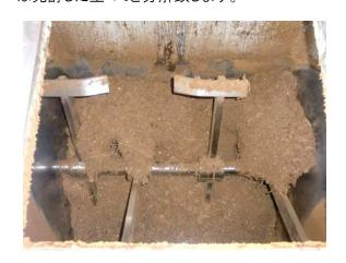
③ その後、約24時間程で生ゴミは完全に(一部分解できない物を除く)堆肥化されます。
