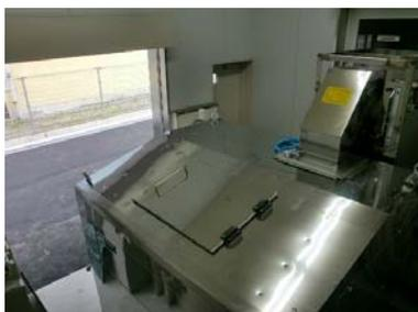
③ 生ごみ投入後、投入口を閉めると機器は自動運転モードにて運転を再開します。
