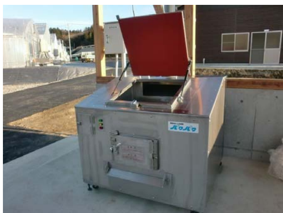
■1 槽式 50kg 処理／日(平成 25 年 12 月導入)
